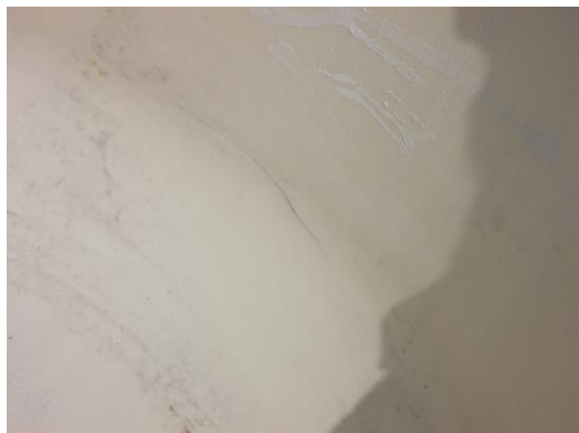
Рис. 1,2 Трещина внутренней колбы в результате транспортировки в условиях низкой температуры (менее: -15^{\circ}\text{C} ).
