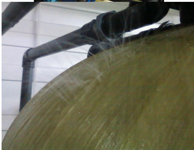
Рис. 3,4 Последствия образования трещины внутренней колбы.
