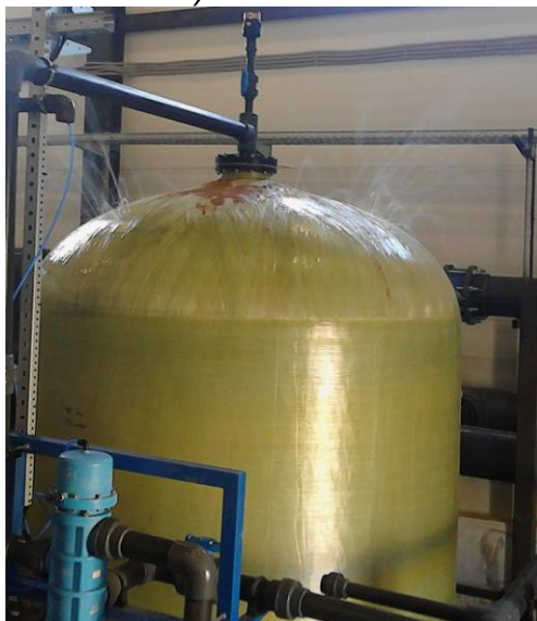
Рис. 1,2 Трещина внутренней колбы в результате транспортировки в условиях низкой температуры (менее: -15^{\circ}\text{C} ).
