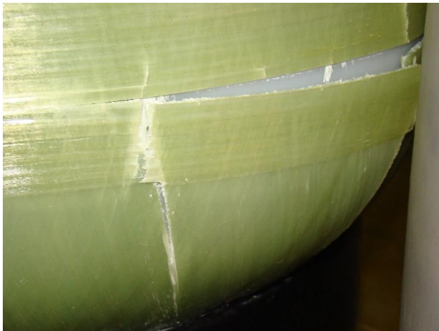
Рис. 5, 6 Разрушения в результате воздействия внутренних сил при эксплуатации фильтра в условиях низких температур (заморозка).
